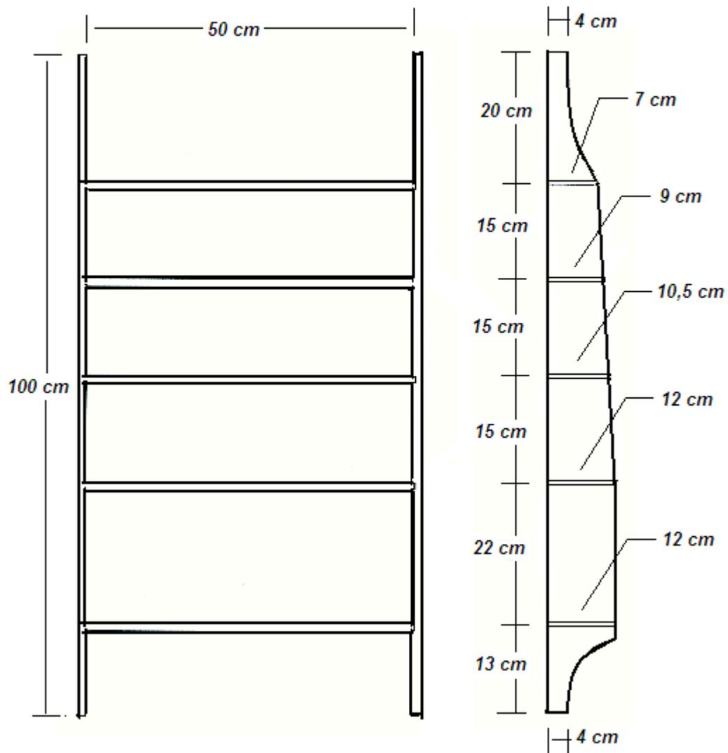
Depois de cortadas as peças, Lixe nas linhas de corte para suavizar as marcas da serra, mas este lixamento é só uma limpeza.
