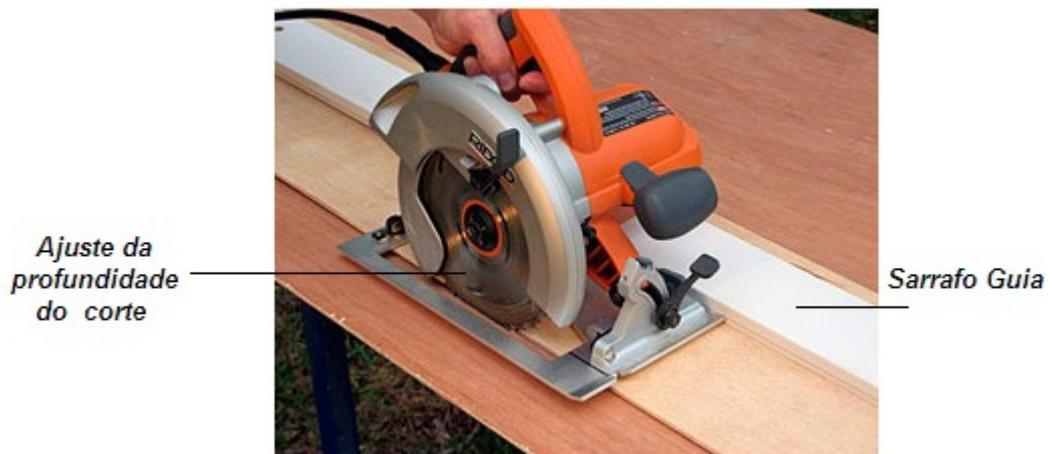
Agora ajuste a profundidade do corte, deixando a altura da serra na metade da espessura da madeira, para fazer o encaixe para as prateleiras. Para a fixação a montagem deverá ser feita usando-se cola para madeira e pregos finos sem cabeça.
